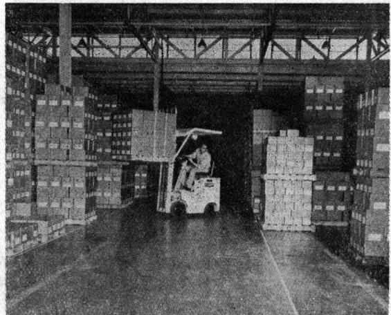
えなければならぬ。オレゴン州の或る電気補充倉庫を焼失した火災は、電気リフト・トラックが針金のコイルの荷積の中へバックして入つた時に起つたと報ぜられてゐる。コイルは麻布と特殊な包み紙で包まれて居たが、多分此の物質がトラックの電池の導線の短絡による火花から着火したものだらう。
