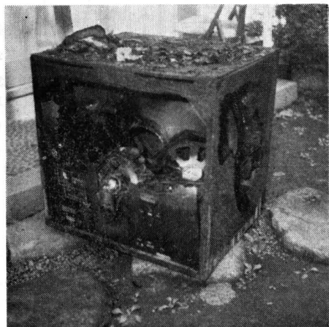
写真 2 テレビの焼損状況 37 年 11 月、目黒区、21 インチカラーテレビ、アメリカ RCA 製
