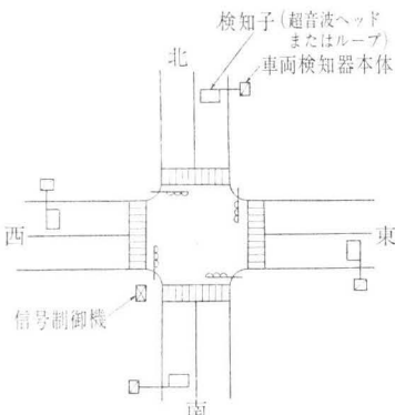
第7図 地点感應信号機の車両検知器配置
