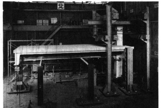
写真2 新宿三井ビル柱はり接合部の構造実験
