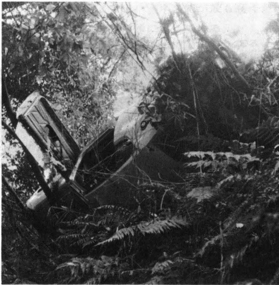
普通乗用車を時速50kmで運転中、追い越しのため右側へ出た直後、路面がぬれていたためスリップし暴走。4 m下の崖下へ転落、大破したが、シートベルト着用のため負傷しなかった(52. 12 滋賀)。
