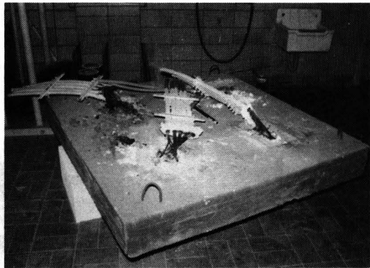
写真7 電線の火炎伝ば性試験装置
