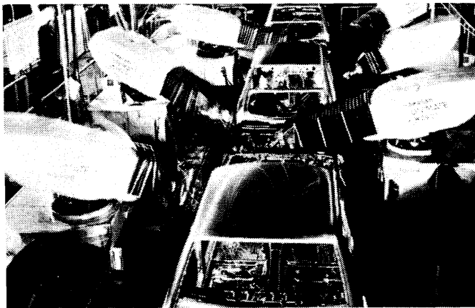
写真2 機械間の搬送作業を行う走行型プレイバックロボット
