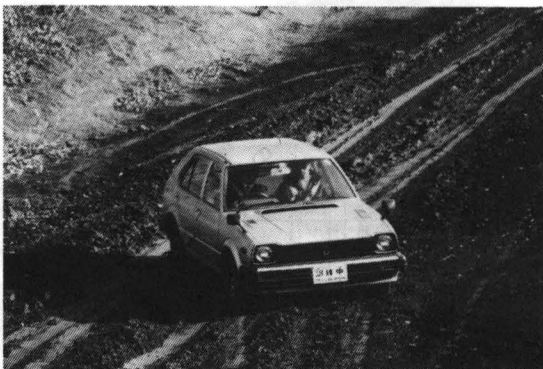
写真2 スキッドが始まると、もうハンドル操作で姿勢を制御すること(自動車が進行方向に正しく向くこと)が不可能になり、そのまま横滑りで下りるか、スピン状態となってしまう。
