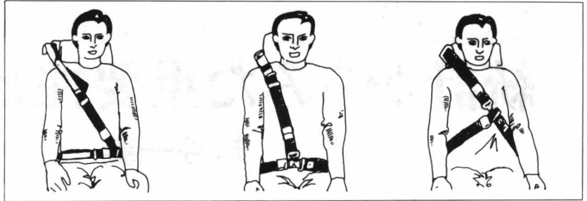
タイプA着用状態(正しい着用法) タイプB着用状態(バックル位置が不適、腹部中央に寄りすぎている) タイプC着用状態(バックル位置不適、およびラップベルト位置不適当)
