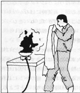
ぬれたシーツによる消火（シーツを盾に近づく→火炎の上から覆いかぶせる→消火成功）
