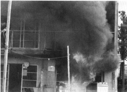
実験1 フラッシュオーバー（2階開口部開放時）
