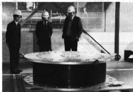
写真9 原子力プラント免震用積層ゴムの試験体
