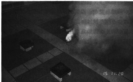
写真5 実大煙流動実験 基底部の煙発生状況(オイルバン4か所と発煙筒1か所)
