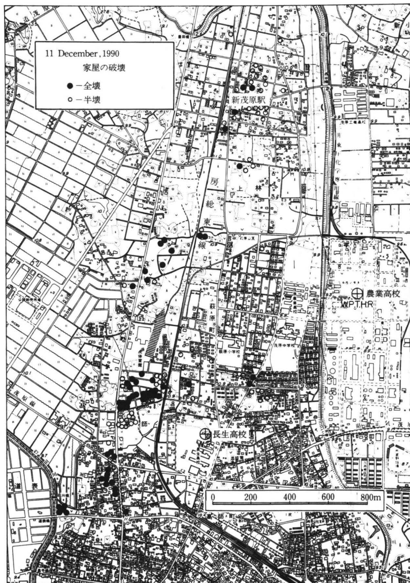
図1 竜巻による茂原市の家屋被害分布(茂原市役所調査)
