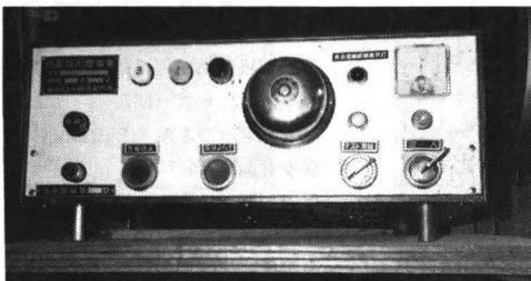
地震指示警報器(地上で発信器から受信する機械装置/のと鉄道)
