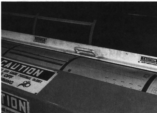
写真1 回転部分に付設されたフィンガーガード
