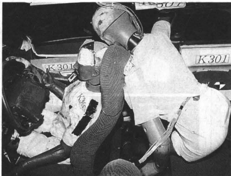
写真9 衝突後の状況（シートベルト非着用では後席ダミーが前席シートを乗り越えている）
