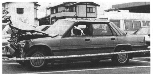
写真3 普通乗用車の破損状況
