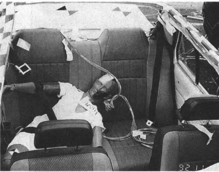
写真8 衝突後の状況（シートベルト非着用では前席シートが破壊されている）
