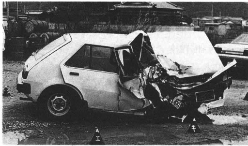
写真7 B車の破損状況
