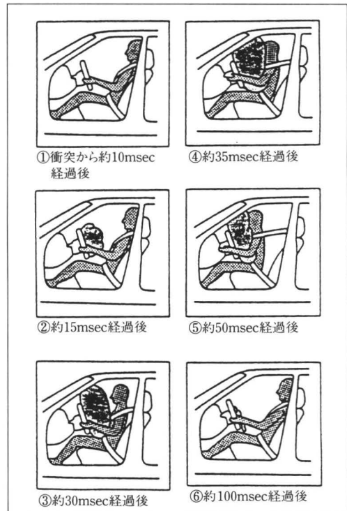
図11 エアバッグ作動プロセス
