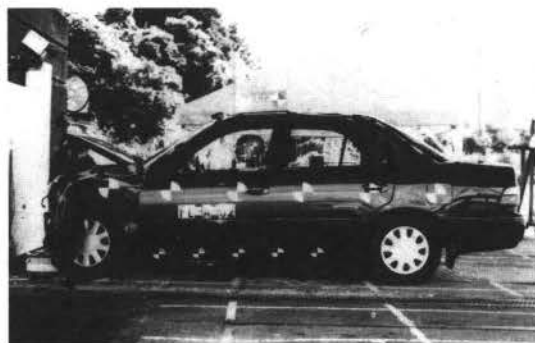
フルラップ衝突試験後の試験車（側面）
