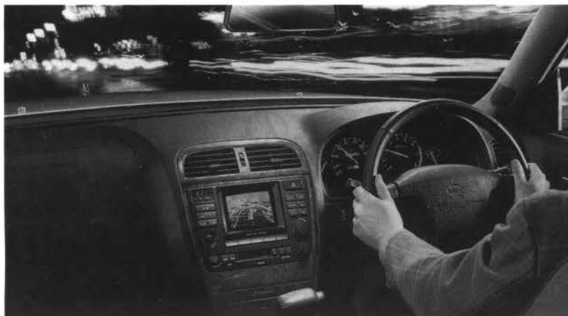
自動車メーカーが開発、製造時に車両に組み込むシステムの現状例。ディスプレイ位置は低めで、操作も画面に触れる／小さなボタンを押すなど、運転者の負荷は大きい。
