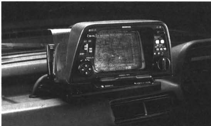
ホンダ・エレクトロ・ジャイロケータ。 軌跡だけを表示するCRT画面に透明シートに印刷した地図を重ねる。
