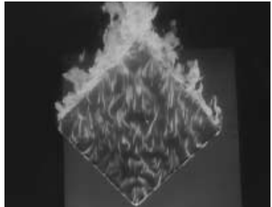
写真7 着火数秒後のウレタンマット..... 多量の黒煙を出しながら急速に燃焼する。
