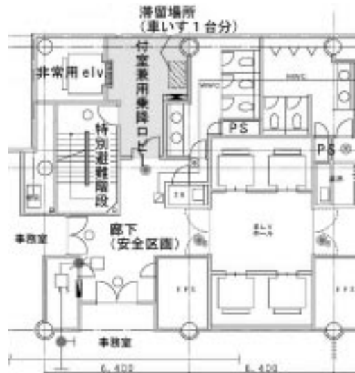
図2 待避区画の実例：大和ハウス金沢ビル 防火区画され排煙設備が設置された非常用エレベータ乗降口ビー兼用特別避難階段付室内。滞留場所として、車いす1台分の滞留に必要な寸法 (幅80cm・奥行き120cm程度) を確保。滞留場所の占有が可能 (非待避者の動線ならびに消防隊の活動スペースと重ならない)、滞留場所の表示と双方向の通信機能がある。 [ 図面提供 ] 大和ハウス工業
