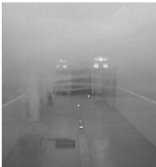
写真1 光点滅走行避難誘導システムの例 実験火災での煙中の状態。ある間隔で床に埋め込まれた点滅光が避難方向に走行（順番に点滅）。上方は通常の誘導灯。
