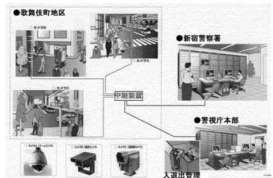
図1 警視庁の街頭防犯監視カメラシステム
