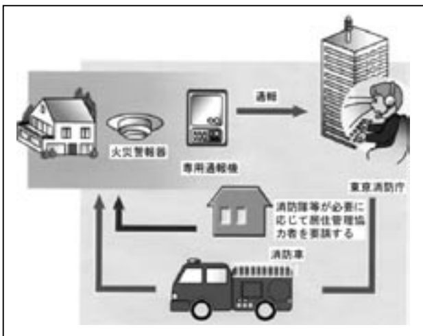
図6 火災安全システム
