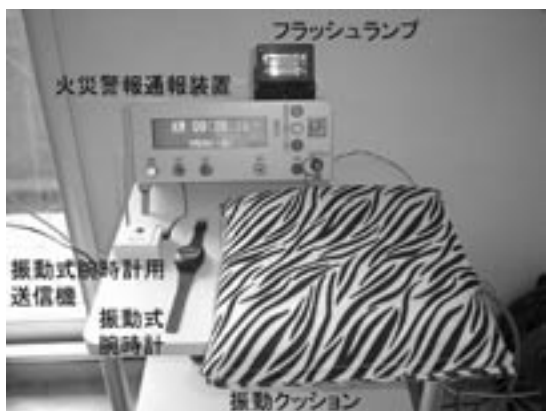
図2 火災警報・通報装置の外観
