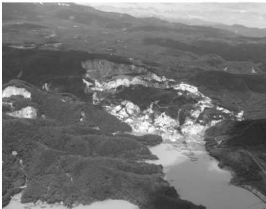
写真7 荒砥沢ダム上流部の大規模崩壊(朝日新聞社のヘリコプターに同乗して撮影)
