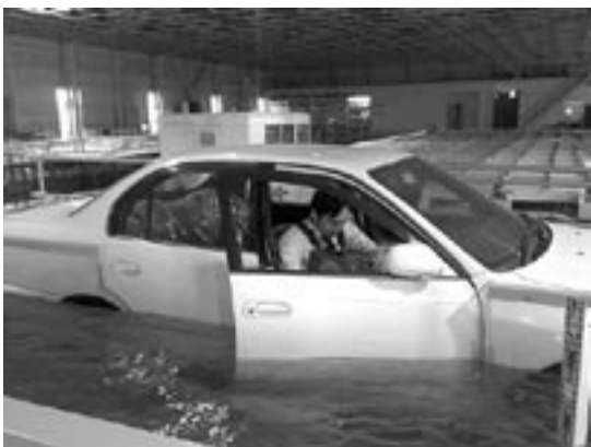
写真2 実物大模型を用いた自動車からの避難実験
