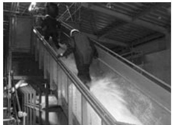
写真1 実物大模型を用いた階段からの避難実験
