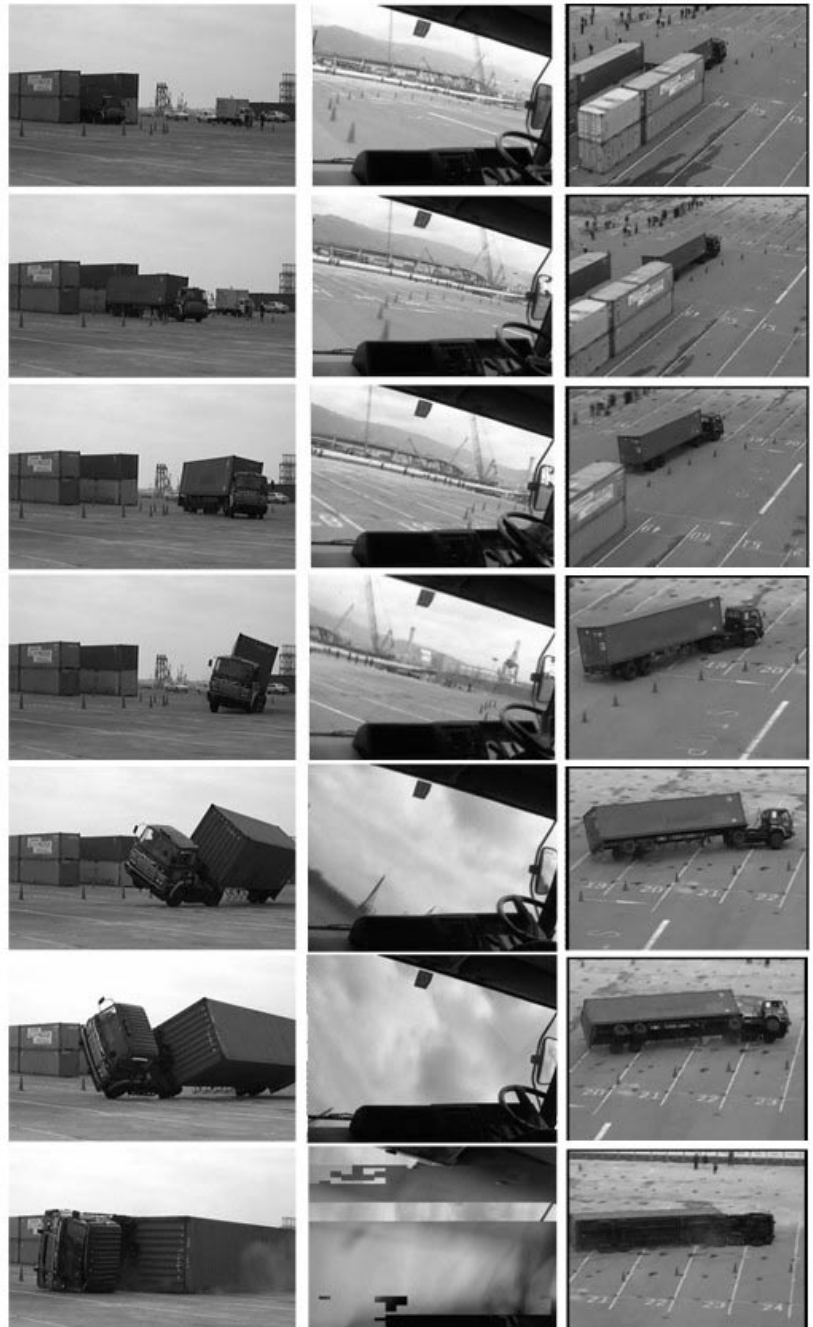
図3 2005年4月に神戸港で行なわれたトレーラー横転実験（著者、よみがえれ神戸港推進委員会、神戸市みなと総局ほか関係各位による共同実施）
