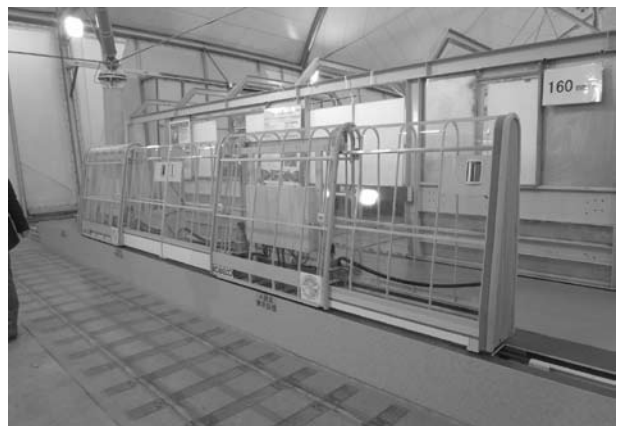
図7 東大・神戸製鋼が開発中の新型ホーム柵試験機
