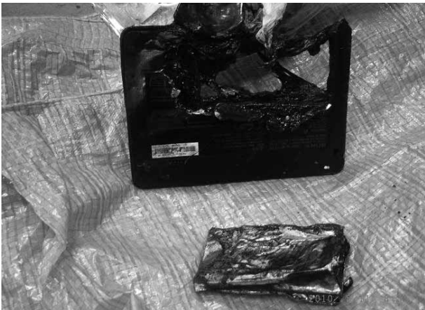
写真13 ポータブル DVD プレーヤーに内蔵された充電式リチウムイオン電池
