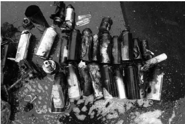
写真6 焼損したスプレー缶
