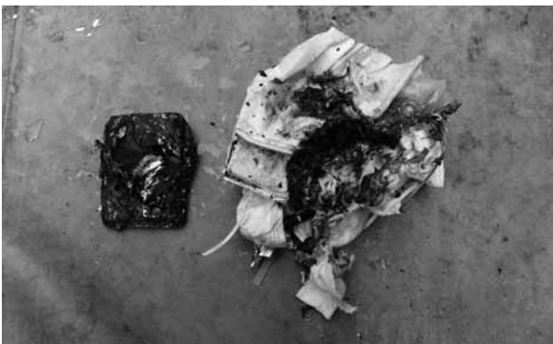
写真14 出火した充電式リチウムイオン電池（左）と着火したごみ
